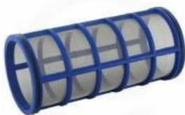
Pour ce faire, trois niveaux de filtration peuvent se monter. Une filtration en sortie de pompe, une filtration par tronçon, puis une à chaque buse (de la filtration la plus grossière à la plus fine). Les constructeurs de buses vous indiquent la filtration appropriée suivant le type de buse utilisée. L'unité retenue pour déterminer la finesse de la filtration est le « MESH ». Un nettoyage de ces éléments après chaque traitement est conseillé.
