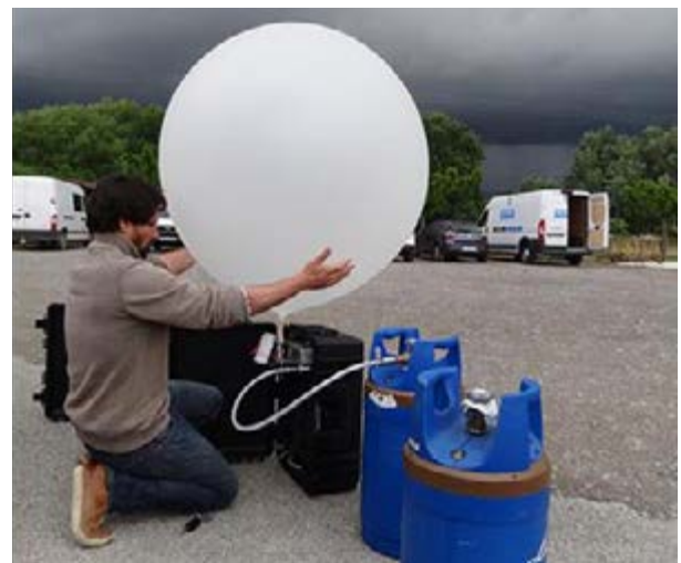
Le ballon peut être gonflé et déclenché à distance via un automate, ou sur place par le viticulteur quelques minutes avant l'arrivée du nuage d'orage.
