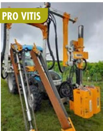
La machine est équipée de bandes conductrices pour la végétation en déroulant des ficelles qui sont agrafées entre elles déclenchement manuel
